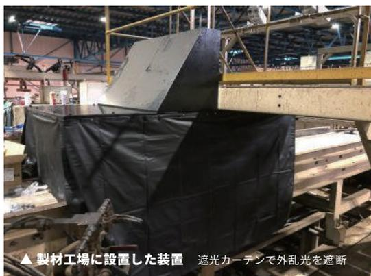
▲ 製材工場に設置した装置 遮光カーテンで外乱光を遮断
