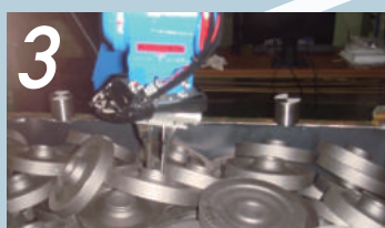
ロボットハンドによる部品の把持
